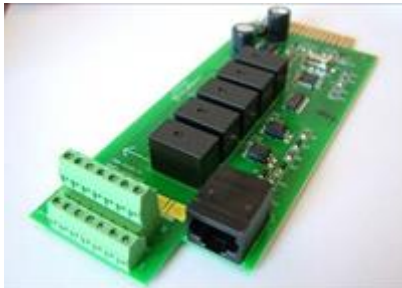
155. ábra 4 AS400 relékártya az UPS valós idejű vezérléséhez.
